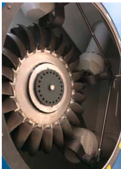
Lieferung Montage des neuen Pelton turbine
